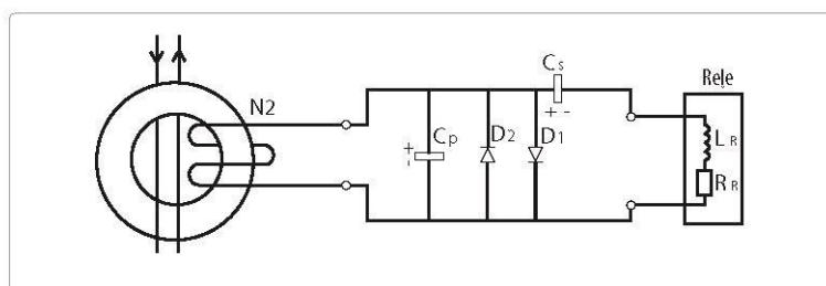
Krug je odgovarajućim spojem usklađen s frekfencijom kojom se dobija najveći učinak i iskorišćenost izlaznog signala na sekundarnoj strani, a samim tim i optimalno delovanje releja pri nazivnoj frekfenciji. Uopšteno se može reći da sklopka A tipa odlično reaguje na sinusne i jednosmerne pulsirajuće diferencijalne struje s frekfencijama 50Hz i onima do neke treće harmonijske frekfencije, dok kod frekfencija većih od 1 kHz osetljivost sklopki tipa A pada.
