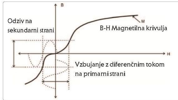
Gore je prikazana B-H magnetilna kriva diferencijalnog transformatora. Jačina magnetnog polja je zavisna od pobude diferencijalne struje, u jezgru transformatora se tada razvije magnetni fluks  $B$ , u skladu s tokom B-H krive. Zbog dovoljno velikog magnetnog fluksa  $B$ , indukovaće se napon na sekundarnoj strani i uzrokuje struju okidanja u okidnom releju.
