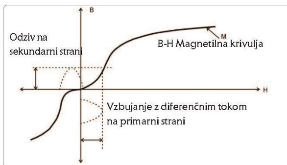
Vidimo da je odgovor na sekundarnoj strani upola manji, što znači da moramo taj signal povećati na neki način. To se ostvaruje sa posebnim spojem u sekundaru transformatora, što je prikazano.
