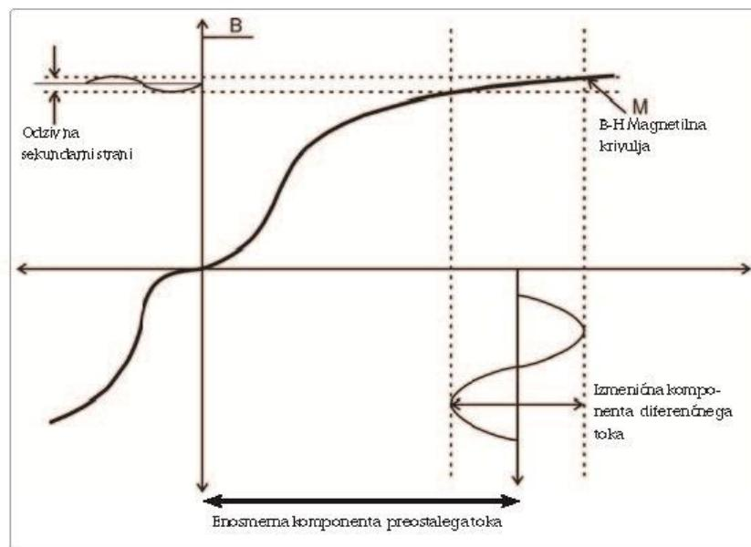
Posve je jasno da diferencijalni transformatori ne razaznaje čistu jednosmernu struju, tako AC- ili A-tip zaštitne sklopke nisu osetljive na čisto jednosmernu struju greške. Još veći problem je prikazan na prethodnoj slici, gde je prikazano stanje u slučaju pojave
